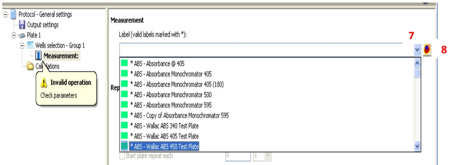
E. 点击右侧下拉三角（7），选择一个将要进行的测定，如第一个光吸收 ABS-Absorbance @ 405。此处相当于从操作源中选择一个测定模板，选定之后可以进一步修改吸收波长等参数。
