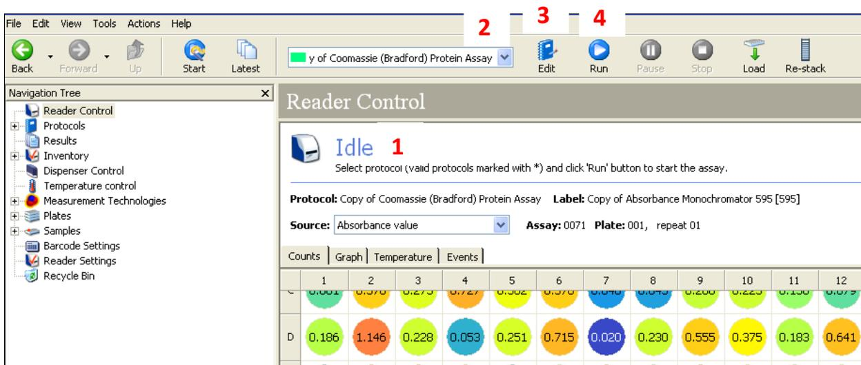
6. 参见上图软件初始界面。可以选择将要运行的程序（2）；可以修改 Edit 选定的程序（3）；可以直接运行 Run 选定的程序（4）
